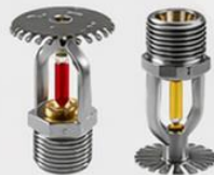
SPRINKLER PENDENTE OU UPRIGHT Bico de Sprinkler, fabricado em bronze, resposta standard, - fator K=5.6 elemento termo sensível bulbo de vidro, acabamento cromado.
